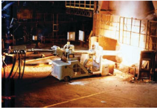
図7 転炉用溶射装置
