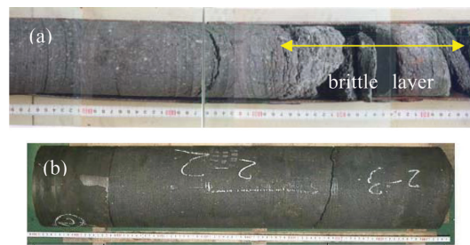
図2 従来(a)及び改善後(b)のカーボンブロックの使用後試料
