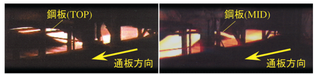
(a) 板先端部の浮上 (b) 板ミドル部の波打ち
