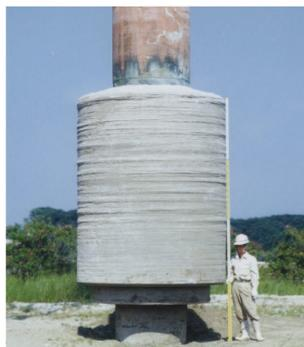
図6 TN-X工法の拡大根固め部(φ2400mm)<sup>28)</sup>
