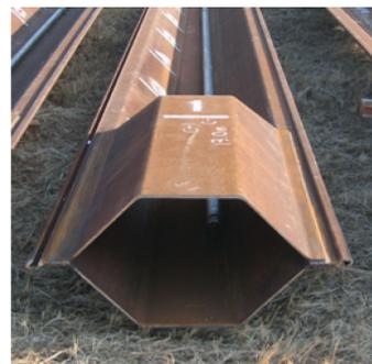
図8 先端部分を閉鎖断面化したハット形鋼矢板
