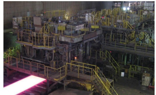
図5 CLC-μとHLの外観(君津製鉄所)
