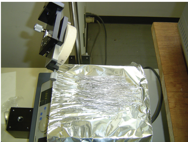
写真2 赤外発光分光法によるワイヤー表面の分析 Analysis of wire surface by infrared emission spectrometry
