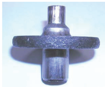
図10 NSSC 160Rの自動車用の強冷間鍛造部品の外観(冷間鍛造のまま)
