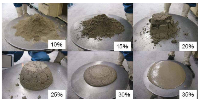
写真4 水分添加量による製鋼スラグ群の流動状況 Influence of additional water on flow situation of slag
