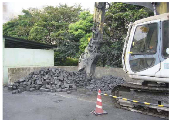
図3 使用後耐火物の回収選別の状況 Classified collection of spent refractories
