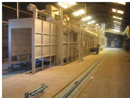
写真8 トンネルキルンの外観(美濃窯業提供) Appearance of tunnel kiln (by Mino Ceramic Co., Ltd.)
