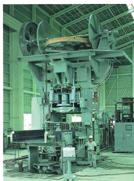
写真5 フリクションプレスの外観 Appearance of friction press
