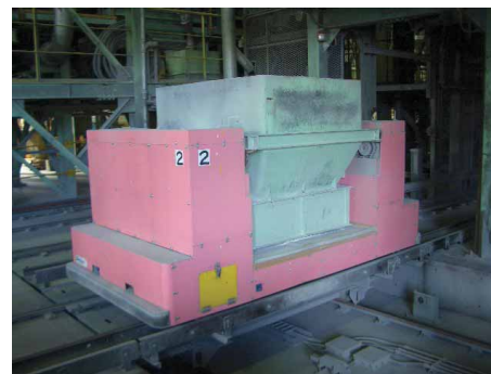
写真2 原料タンクの下を走行する無人秤量台車 Automatic weighing car
