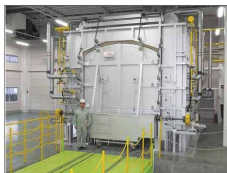
写真9 シャトルキルンの外観(美濃窯業提供) Appearance of shuttle kiln (by Mino Ceramic Co., Ltd.)
