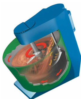
図5 アイリッチミキサー(日本アイリッチ提供) Eirich mixer (by Nippon Eirich Co.,Ltd.)
