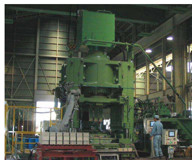
写真6 油圧プレスの外観 Appearance of hydraulic oil press
