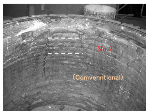
図22 RH脱ガス設備下部槽で試用したNo.2 MgO-C ナノ耐火物の外観(破線の間)
