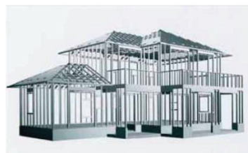
写真1 薄板軽量形鋼とスチールハウス Light-gauge steel shapes and steel framed house
