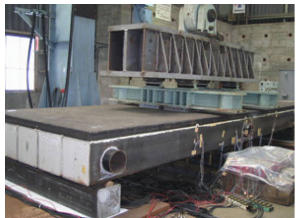
図9 疲労試験の実施状況 Fatigue test set up
