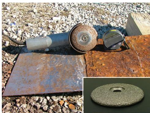
図12 開発工具による異常固着さび除去試験の状況
