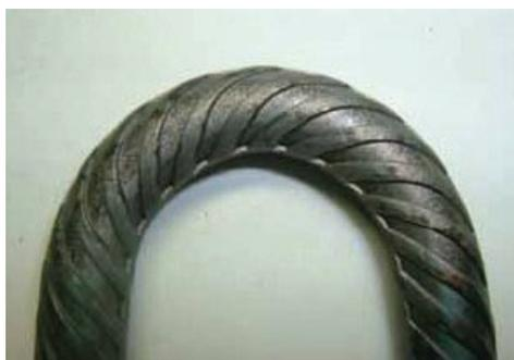
写真3 HDC800/D8の曲げ試験結果
