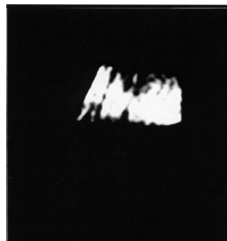
図2 スピネコー法による無処理石炭に重水素ピリジンで膨潤した石炭の2次元イメージ像 2D images of raw coal and with swelling pyridine-d5 obtained by spin echo method
