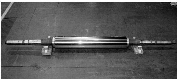
写真2 コンダクターロール外観 EGL conductor roll produced by HIP
