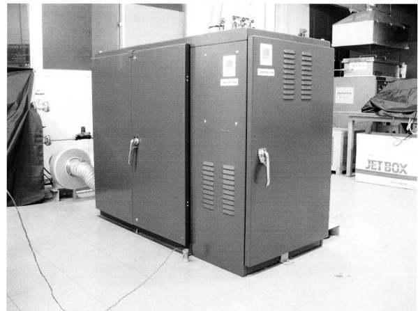
写真1 八幡製鐵所構内で試験中の2kW SOFCシステム 2kW SOFC in Yawata Works
