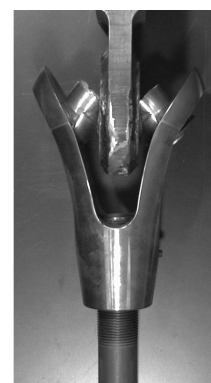
写真6 ピンジョイントの疲労破断状況 Fatigue failure of pin joint
