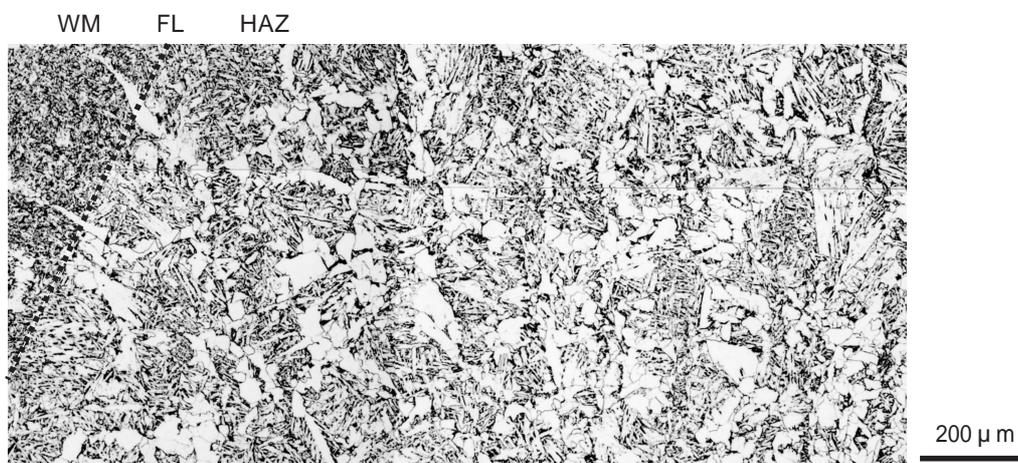
図8 BT-HT440C-HF柱のSAW継手マイクロ組織(角溶接部のフランジ側HAZ)
