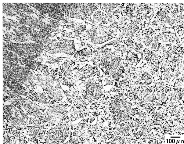
写真2 溶接継手マイクロ組織 Micro structure of welded joint
