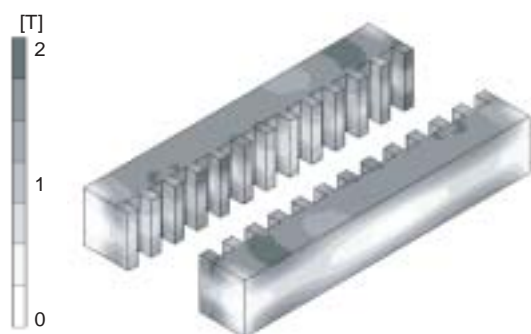
図5 鉄心の磁束密度分布解析例
