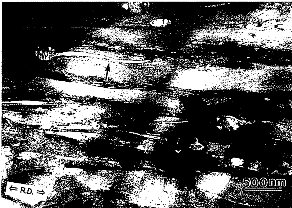
図10 時効熱処理後50%冷間圧延して高 J_c 化したNbTi/Nb/Cu超電導多層板の内部組織(大型のTi析出物は圧延により薄く引き延ばされて約20nm程度まで薄くなっている)
