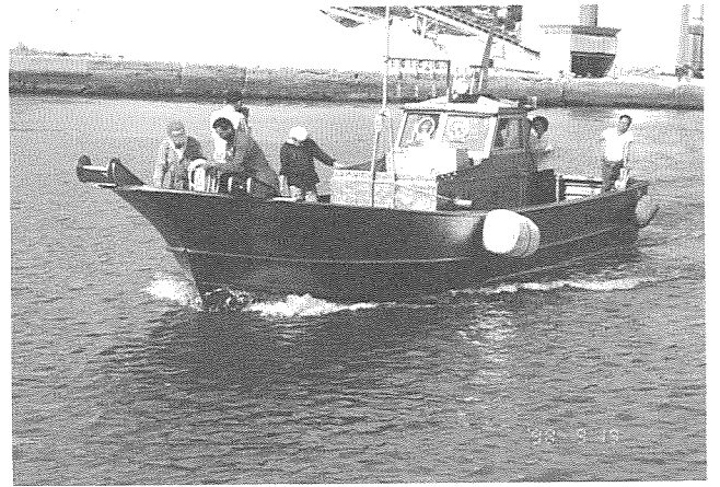
写真4 全チタン製小型船舶(佐賀県唐津市, 1998年進水)
