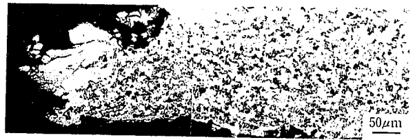
図 11 Ti-47.2at.%Al-2.1at.%Nb 試料の 1473K 引張試験後の断面組織 (粒界に黒くエッチングされている部分が \beta 相)
