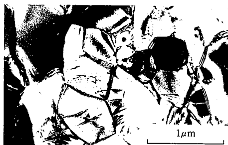
写真 5 水素 0.2% 材の処理 B ( \alpha_M 化 - \alpha + \beta 二相域にて 60% 熱間 圧延) - 脱水素焼鈍後の透過型電子顕微鏡組織
