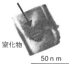
図1 開発鋼の中に分散しているナノ粒子の例
