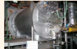
対になった2つのバーナーで吸熱・加熱を交互に行う加熱炉。従来に比べ1/4の省エネルギーを実現
