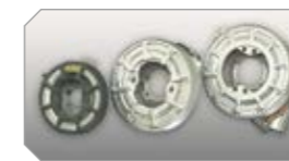
落下衝撃実験(中の2体がハイテン)
