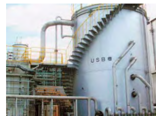
衣浦製造所「排水脱窒設備(USB生物処理)」
