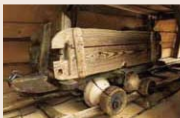
中世ヨーロッパの鉱山で使われた 木製レールと木製車輪
