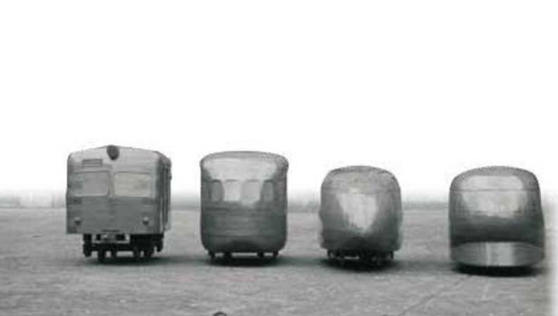
風洞実験用車両先頭部1/12模型
