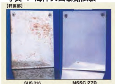
写真-1 海洋大気暴露試験
