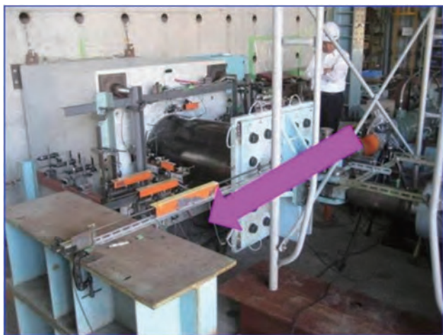
杭頭部の軸力・曲げ試験
