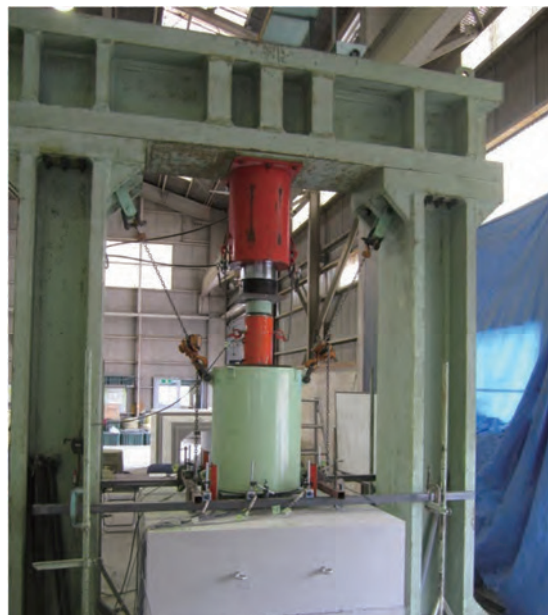
杭頭部押し抜きせん断試験
