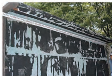
12年経過後の試験体状況 (チタン箔シート剥離後)
