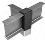
柱頭部斜め切断
