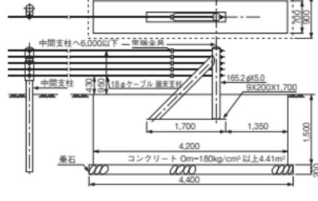
注：1. 下記参考質量は、端末支柱が丸パイプ埋込方式の場合です。角パイプを使用する場合やアンカーボルト方式による場合は、価格表を参照してください。
