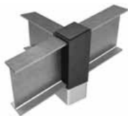
柱頭部斜め切断
