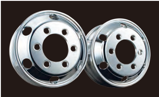
JIS方式 17.5×6.00-6孔 左:10.5kg 右:11.4kg
