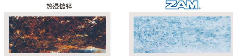
●盐水喷雾试验2500h后,比较两者的表面外观(镀层附着量: 90/90 g/m<sup>2</sup>)
