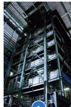
1 退火炉 (立式直接加热还原炉)
