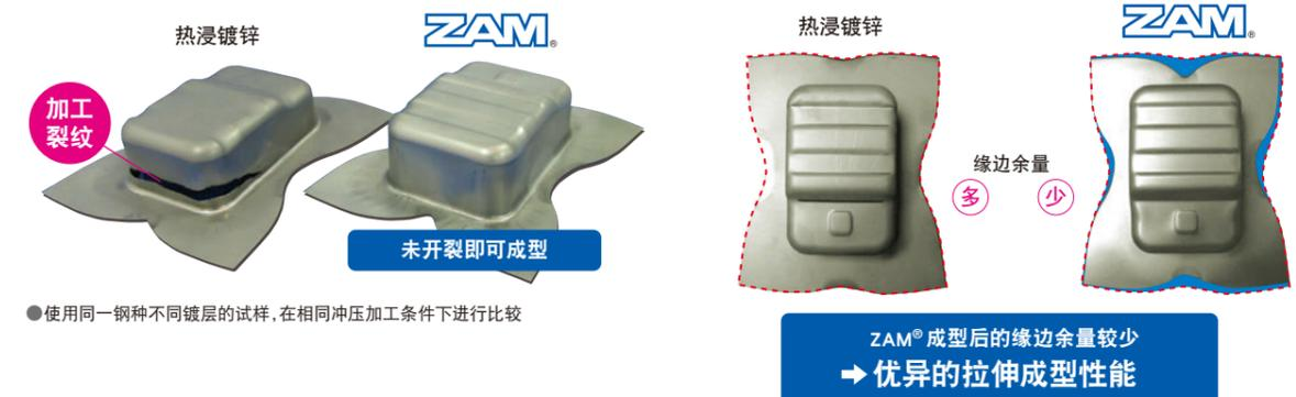
●使用同一钢种不同镀层的试样,在相同冲压加工条件下进行比较
