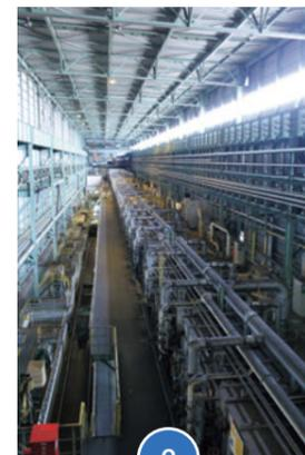
2 退火炉 (卧式辐射加热炉)
