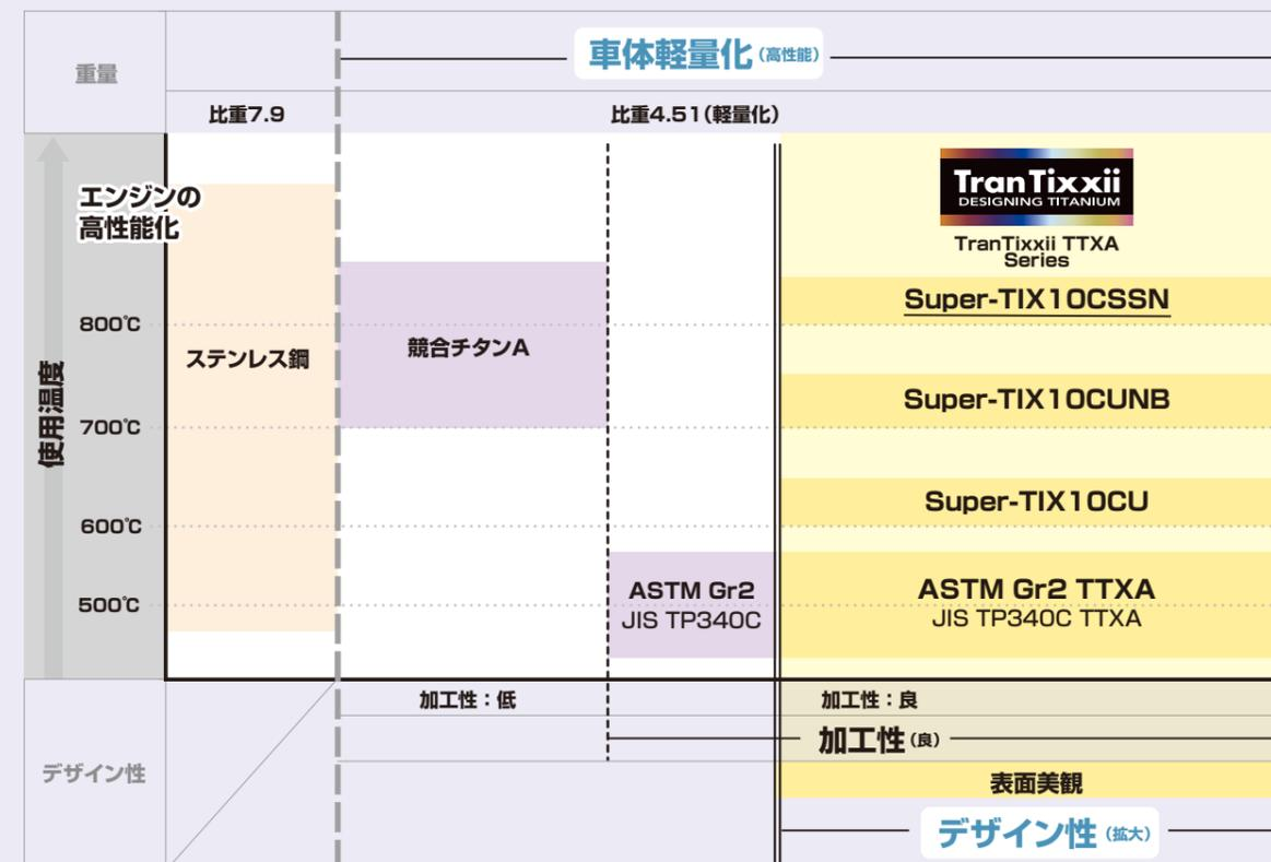
高性能の追求(運動性能) = エンジンの高性能化 × 車体軽量化
