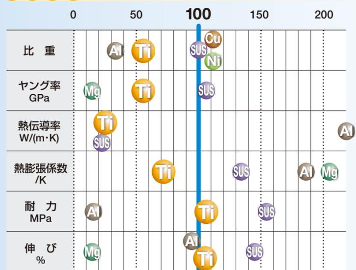
Ti: チタン, Fe: 鉄(SS400), SUS: ステンレス, Al: アルミニウム, Mg: マグネシウム, Ni: ニッケル, Cu: 銅, Fe...鉄の値を100とした場合
