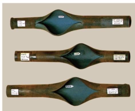
内圧クリープ試験片と破断位置
