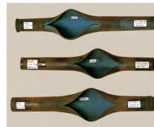
内圧クリープ試験片と破断位置
