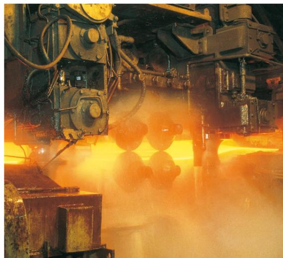
熱間仕上電気抵抗溶接 (SW) の成形溶接機
