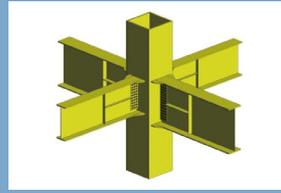
薄肉ウェブ断面の梁端部をスチフナ補剛することで軽量化と耐震性能の向上が図れます。
