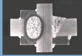
溶接4面ボックス柱の大入熱溶接の効率化や溶接継手性能の向上が図れます。
