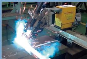
多層盛溶接時のパス間温度の制限を緩和することで溶接効率が向上できます。
