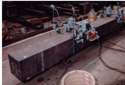
溶接四面ボックス柱のダイヤフラム溶接状況
