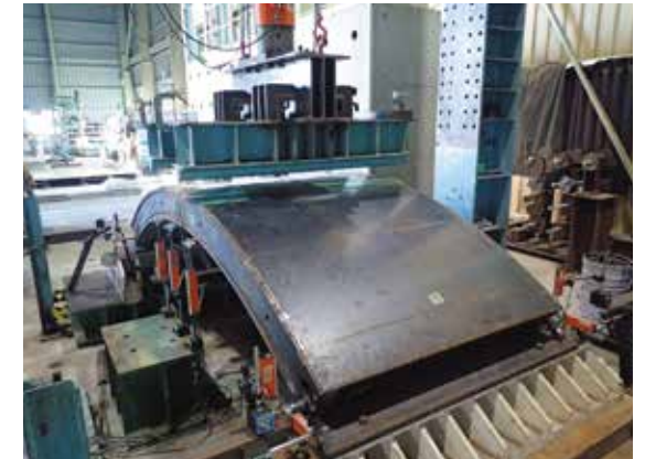
<正曲げ試験状況>
