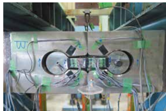
<継手曲げ試験状況>
