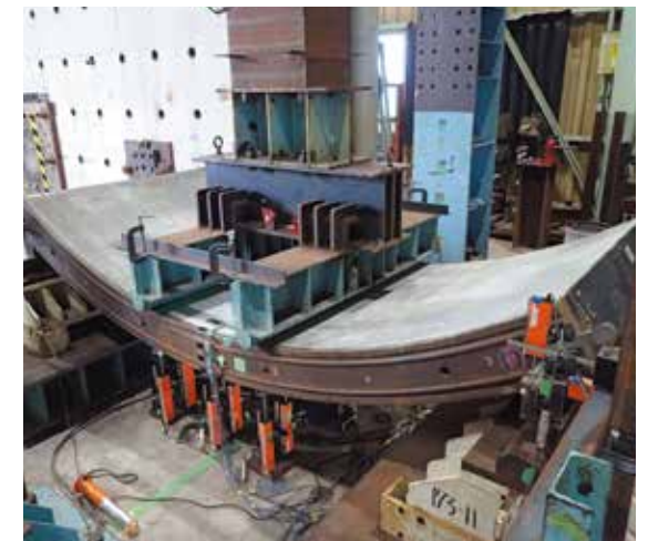
<負曲げ試験状況>
