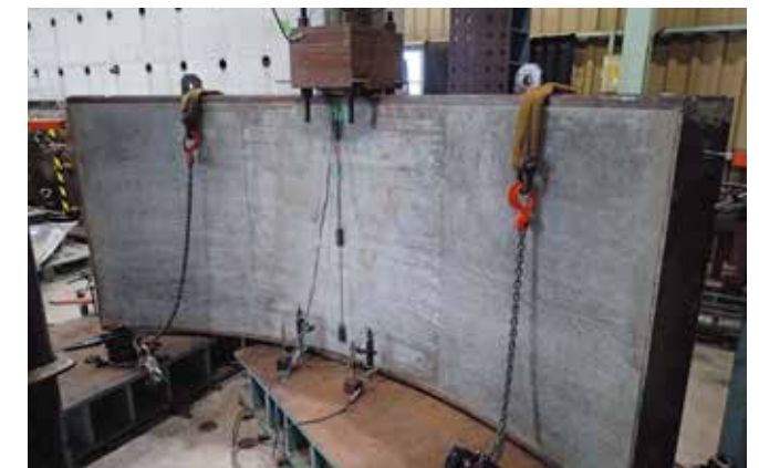
<ジャッキ推力試験状況>
