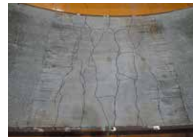
<載荷後試験体 (引張側)>
