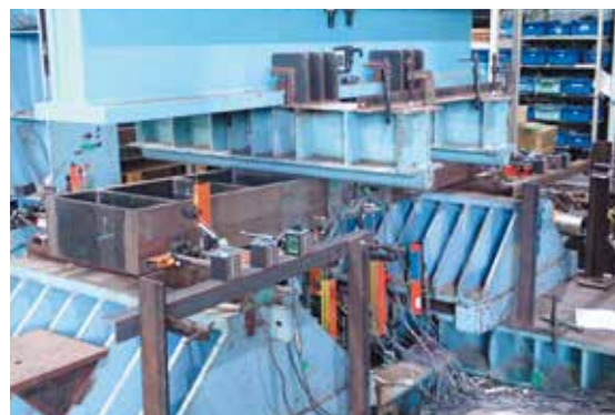
<継手曲げ試験状況>
