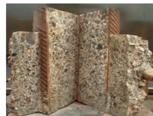
杭先端部築造例 (杭径1,400mm、鋼管径1,000mmの掘起こしカットサンプル)
