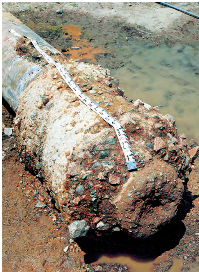
砂礫層での先端根固め拡大球根形成例
