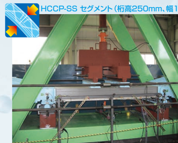
継手曲げ試験 (平板)
