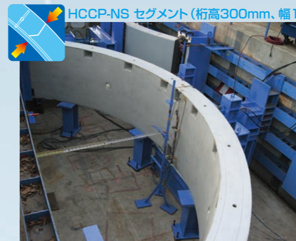
継手曲げ試験 (Aピース)
