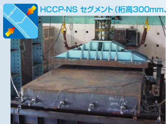
局所面圧載荷試験 (HCCP-NS)
